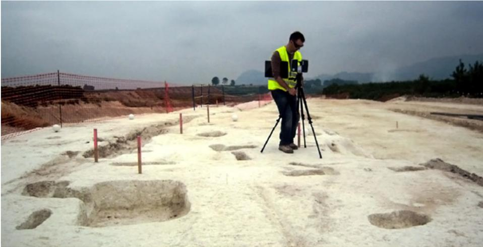
Figura 29.- Colocación del escáner láser en el campo para realizar el levantamiento 3D de una de las fosas. (Cotino *et al.*, 2012, 15).
